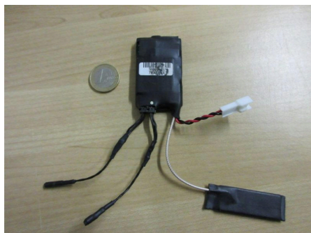
Micros trouvés dans une prise électrique dans un bâtiment à Bologne, Italie, en janvier 2018 1 .
