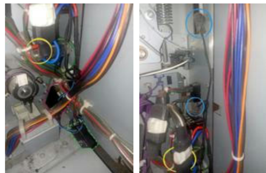
Bleu : micros ; Jaune : fils soudés à l'alimentation ; Rose : boîtier carte SIM + carte SD ; Vert : transformateur
