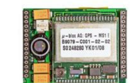
Module fournissant le signal GPS
