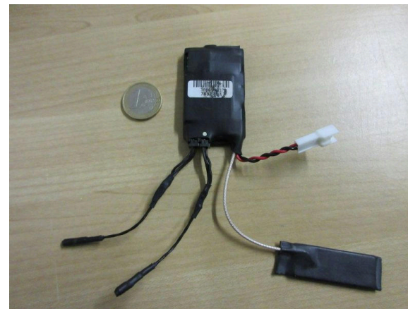
Micos trouvés dans une prise électrique dans un bâtiment à Bologne, Italie, en janvier 2018 1 .
