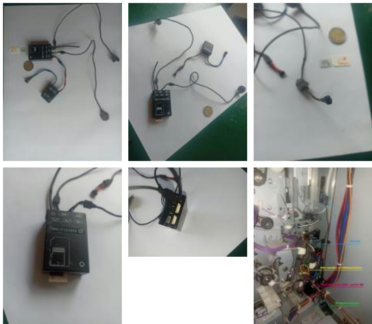
Bleu: micros; Jaune: fils soudés à l'alimentation; Rose: boîtier carte SIM + carte SD; Vert: transformateur
