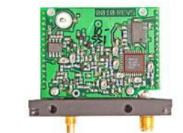
Module permettant la transmission par ondes radio
