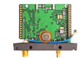
Module permettant la transmission par ondes radio (autre côté)
