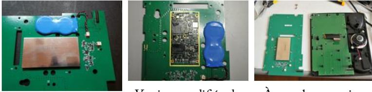
Version modifiée du plus grand circuit imprimé du téléphone (avec dispositif de surveillance). La batterie (en bleu) et le module isolé (en marron clair) font partie du dispositif de surveillance.
