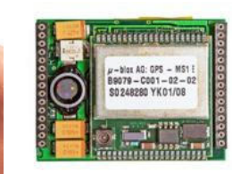
Module fournissant le signal GPS
