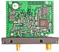
Module permettant la transmission par ondes radio
