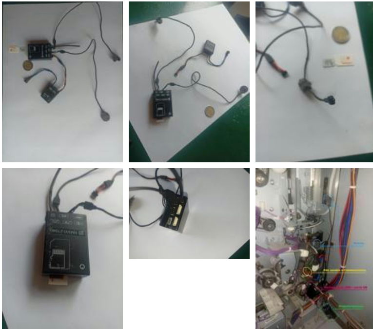
Bleu: micros; Jaune: fils soudés à l'alimentation; Rose: boîtier carte SIM + carte SD; Vert: transformateur
