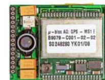
Module fournissant le signal GPS
