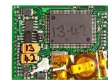
Module fournissant le signal GPS (autre côté)
