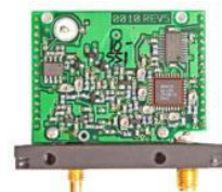
Module permettant la transmission par ondes radio
