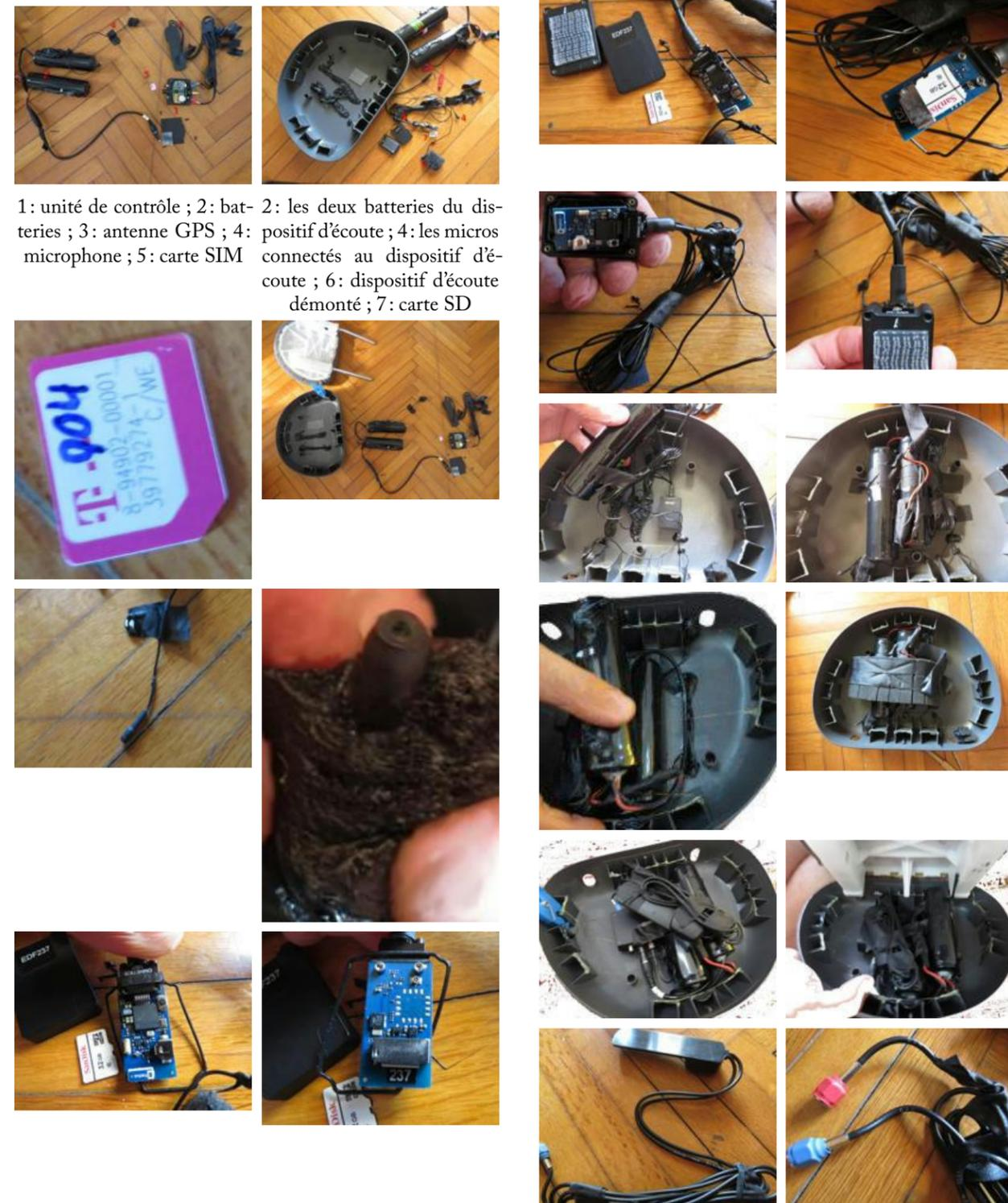
1 : unité de contrôle ; 2 : batteries ; 3 : antenne GPS ; 4 : dispositif d'écoute ; 5 : carte SIM microphone ; 6 : dispositif d'écoute démonté ; 7 : carte SD
