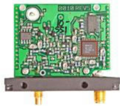
Module permettant la transmission par ondes radio
