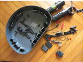
1: unité de contrôle ; 2: les deux batteries du dispositif d'écoute ; 3: antenne GPS ; 4: microphone ; 5: micros connectés au dispositif d'écoute ; 6: dispositif d'écoute démonté ; 7: carte SD
