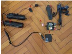
1: unité de contrôle ; 2: les deux batteries du dispositif d'écoute ; 3: antenne GPS ; 4: microphone ; 5: micros connectés au dispositif d'écoute ; 6: dispositif d'écoute démonté ; 7: carte SD
