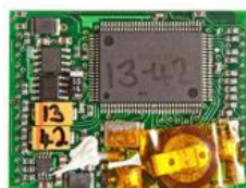
Module fournissant le signal GPS (autre côté)
