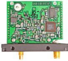
Module permettant la transmission par ondes radio
