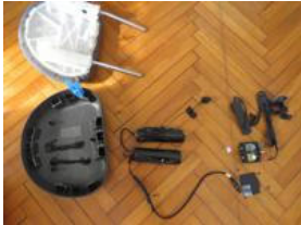
1: unité de contrôle ; 2: les deux batteries du dispositif d'écoute ; 3: antenne GPS ; 4: microphone ; 5: micros connectés au dispositif d'écoute ; 6: dispositif d'écoute démonté ; 7: carte SD
