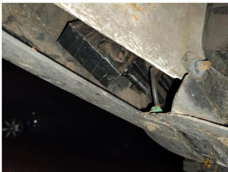
Bild 2.1: GPS Tracker an Seitenschwelle vom Auto
