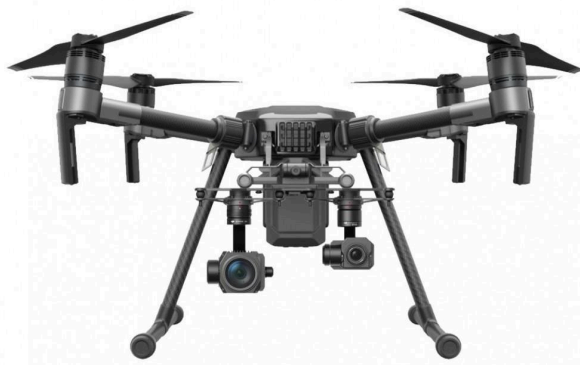
Matrice 210 equipado con cámara Zenmuse Z30 (izq.) y termal Zenmuse XT (der.)
