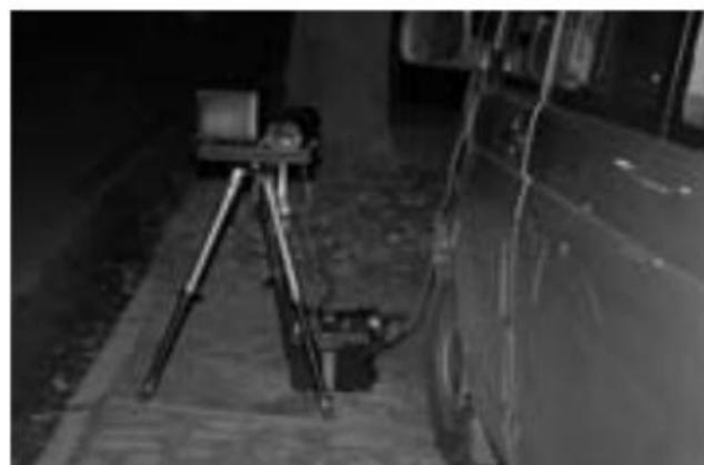
Zwei Kennzeichen-Scanner im Testeinsatz
