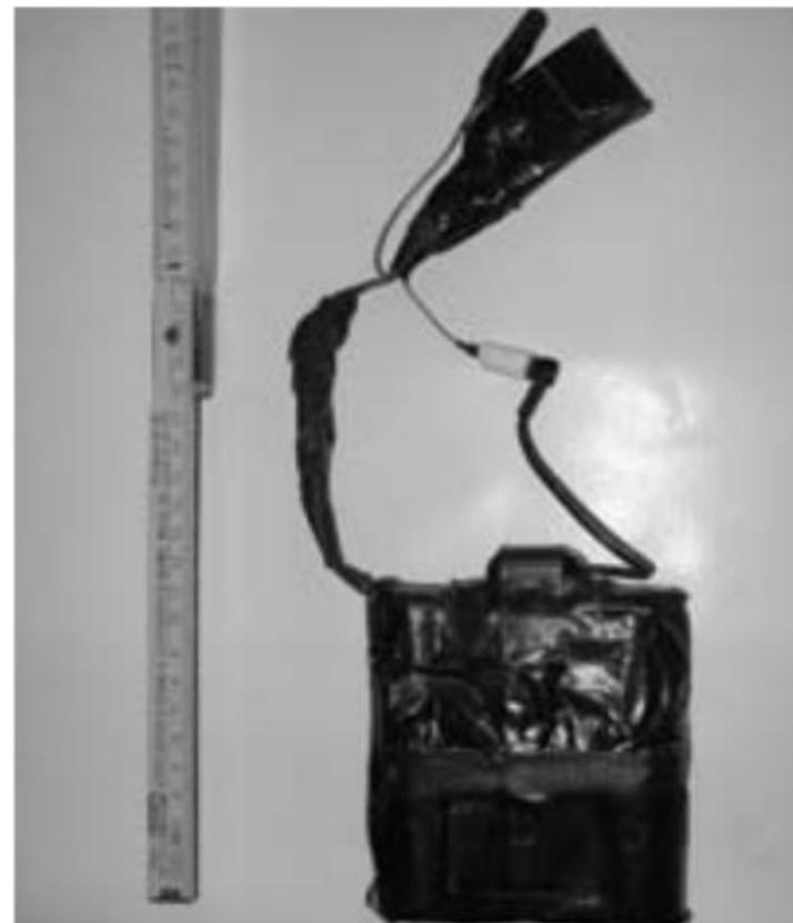
GPS-Sender vom BKA (2007), GPS-Antenne separat
