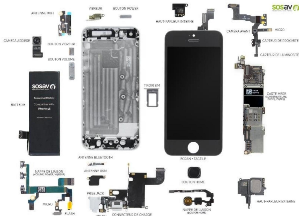
Vue éclatée d'un smartphone avec ses différents composants.
